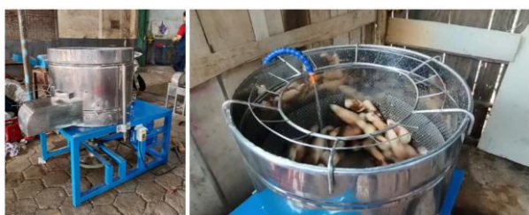
Gambar 9. Mesin Pengupas Singkong
