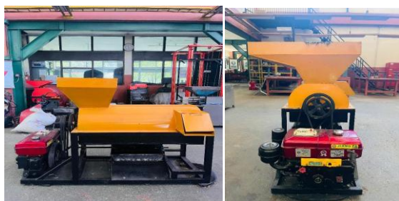
Gambar 11. Hasil Mesin Pengupas dan Pemipil Jagung
