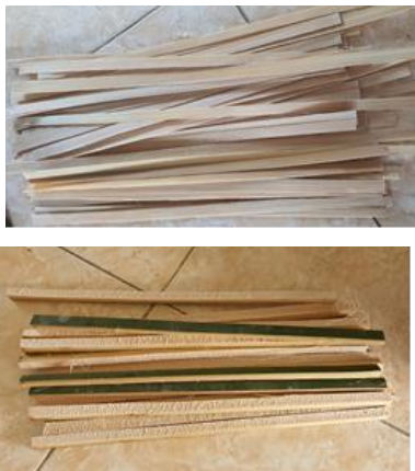
Gambar 10. Hasil iratan bambu yang dipotong dan sudah jadi (Dokumentasi: Nofri Yondra, 2024)
