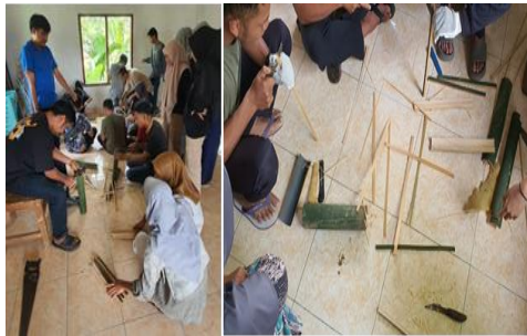
Gambar 9. Proses membuat iratan menggunakan parang dan pisau raut (Dokumentasi: Hamzah, 2024)
