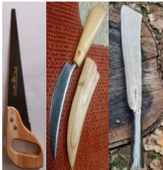
Gambar 7. Jenis-jenis alat yang digunakan untuk memotong dan meraut bambu (Dokumentasi: Ramadhani Kurniawan, 2024)
