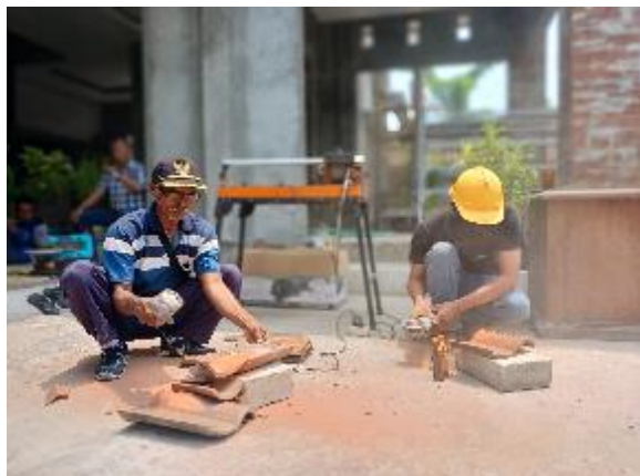
Gambar 2. Demonstrasi Proses Pengolahan Limbah Genteng Menjadi Penutup Dinding Estetis dan Roster
